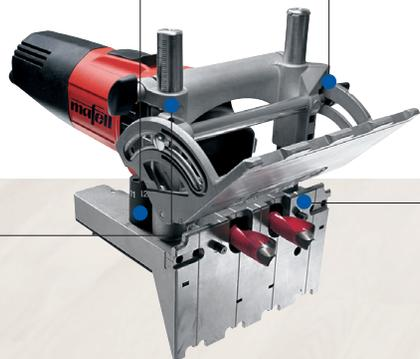
Der Schwenkansschlag wird beidseitig geführt und geklemmt.
