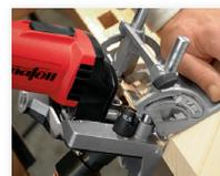
Schnell und exakt: Eckverbindung stumpf oder auf Gehrung.
