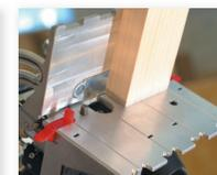
Mit den Zusatzanschlägen lassen sich kleinere oder größere Randabstände schnell und präzise erzielen.
